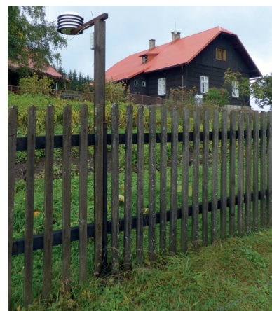
Obr. 1 Příklad instalace teplotního čidla Termio (lokality Staré Hamry, Gruň, 22. září 2017, foto: Pavel Lipina).
