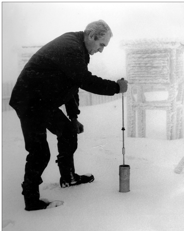
Vzorek pro měření vodní hodnoty sněhové pokrývky odebírá Dušan Rodovský (zima 1987/1988).
