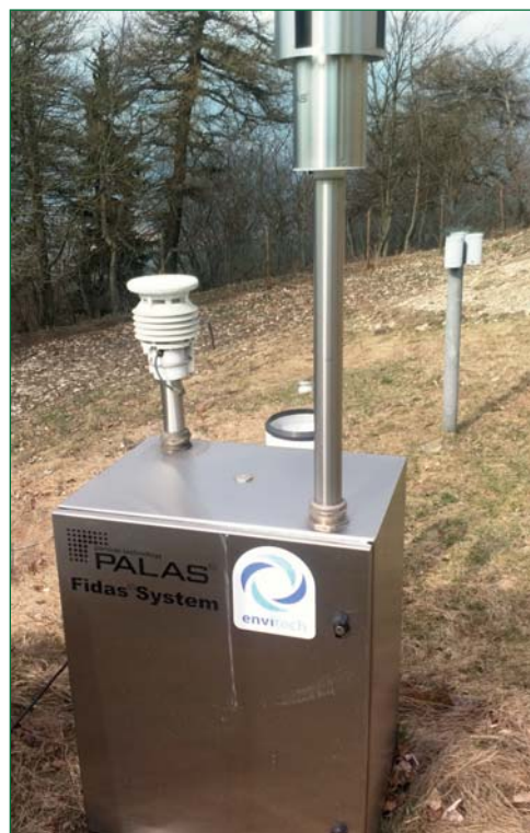
Obr. 3 Měřicí přístroj pro měření množství prachu. Foto Petr Pešice.
