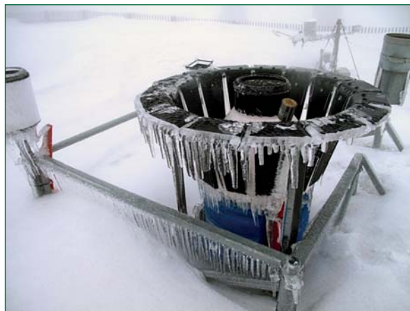
Obr. 3 Srážkoměry na rampě pod ledovkou, Lysá hora 13. 3. 2012, foto Stanislav Ondruch.
