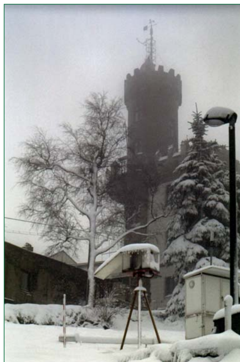
Obr. 1 Aktivní odběrové zařízení pro sběr vody z mlhy. Foto Petr Pešice.
