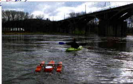
Měření průtoku pomocí přístroje ADCP (akustický dopplerovský měřič průtoků). Water discharge measurement by means of an ADCP instrument (acoustic Doppler discharge meter).
