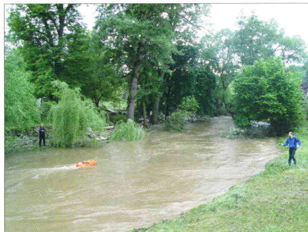
Obr. 6 Měření průtoku přístrojem ADCP – Rio Grande v blízkosti stanice Radč – Mastník, 4. 6. 2013 14:00 UTC, Q_{měř} = 41,5 \text{ m}^3 \cdot \text{s}^{-1} , Q_{kulm} = 103 \text{ m}^3 \cdot \text{s}^{-1} , přemísťování měřícího člunu metodou přetahování lana.
